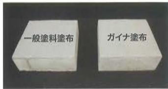
▲一般塗料塗布コンクリートとガイナ塗布コンクリートを用意。コンクリートの厚みは、50mm。
