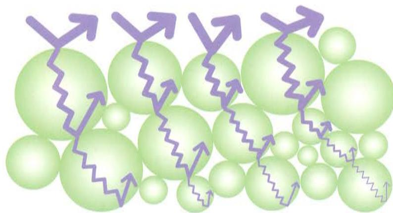
ガイナの塗膜は、硬いセラミックの中に空気を含んだ球体の多層で構成されています。
