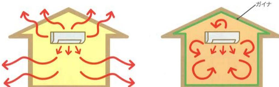
室内空気温度がいくら高くなつても、壁・天井の温度が低ければ、熱は壁・天井から逃げます。
