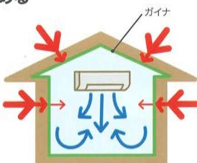
室内空気温度がいくら低くなつても、壁・天井の温度が高ければ、熱は室内へ侵入します。
