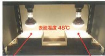
▲それそれを実験機に設置し、一般塗料塗布コンクリートの表面温度が 48°C になるようライトを照射して、それぞれの裏面温度を計測。
