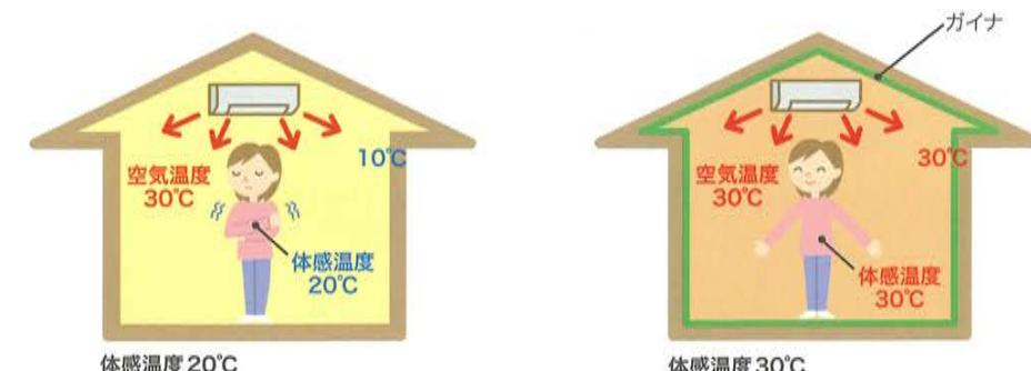
室内空気温度が30°Cで、壁・天井の表面温度が10°Cである左図の部屋の体感温度は20°Cとなります。 $(30°C + 10°C) \div 2 = 20°C$ 。
