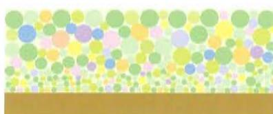
ガイナは、特殊セラミック層で構成されています。この特殊セラミックが、周辺温度に適応する性質があり、その結果、熱の均衡化をもたらし、熱の移動を抑える働きをします。
