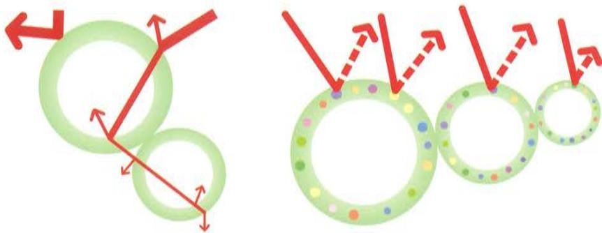
ガイナの球体セラミックに侵入した太陽光に含まれる赤外線は、球体のプリズム効果により、反射と屈折を繰り返し、屋内に侵入するエネルギー量を減少させていきます（左図）。
