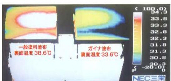
▲一般塗料塗布コンクリートの裏面温度は、38.6°C、ガイナ塗布コンクリート裏面温度は、33.6°C となった。
